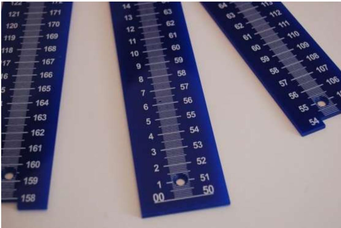
DETALLE DE LA BASE (La marca 0 se ubica a 50cm del piso) Y ENCASTRES DEL TALLÍMETRO. DEL LADO IZQUIERDO (comenzando de 50cm) SE UTILIZA PARA LA TALLA TOTAL, DEL DERECHO (comenzando de 0cm) PARA LA TALLA DE SENTADO SOBRE UNA CAJA ANTROPOMÉTRICA DE 50cm DE ALTURA Y BASE PLANA
