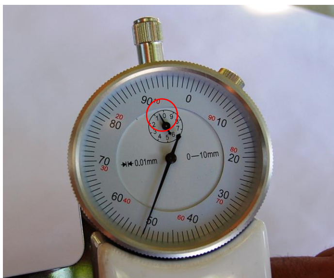
FOTO C – Plicómetro abierto en 5,1mm. Puede apreciarse la aguja pequeña ubicada entre 0 y 1 (1° vuelta)
