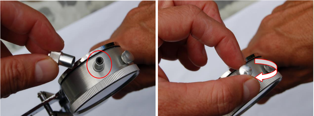
FOTOS G y H – Orificio para lubricación (izquierda), y sentido de ajuste del tornillo superior (derecha)
