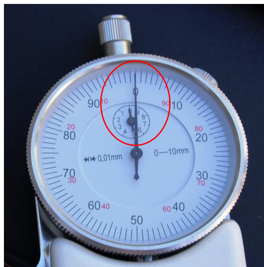
FOTO I – Se observan las agujas del cuadrante menor y la principal en cero (0), con el plicómetro cerrado
