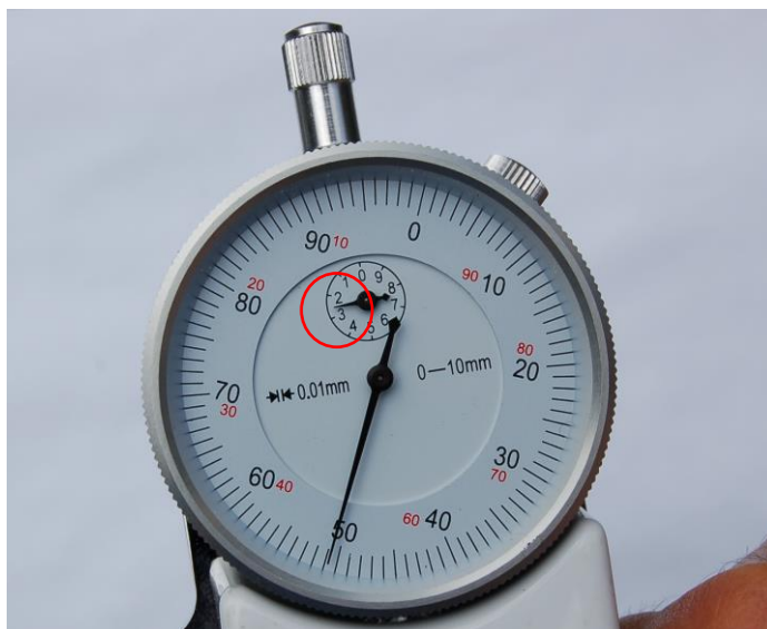
FOTO E – Plicómetro abierto en 25,1mm. Puede apreciarse la aguja pequeña ubicada entre 2 y 3 (3ª vuelta)
