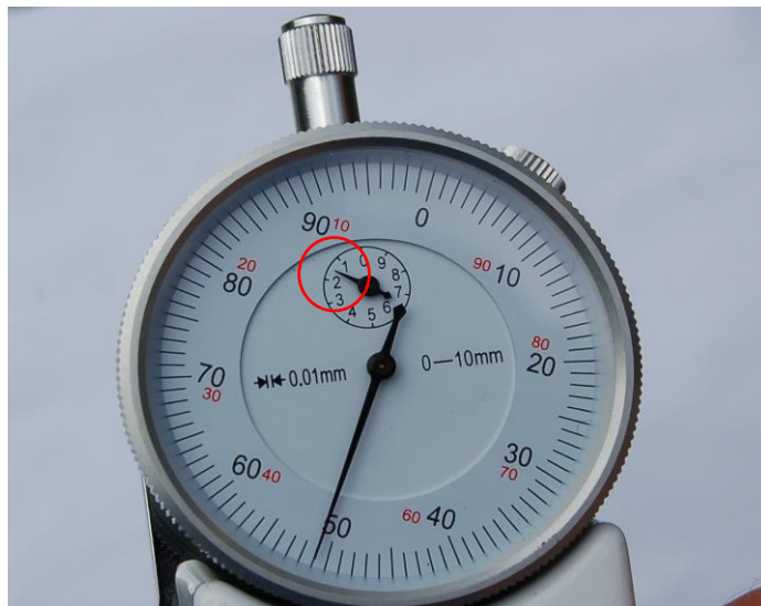
FOTO D – Plicómetro abierto en 15,1mm. Puede apreciarse la aguja pequeña ubicada entre 1 y 2 (2ª vuelta)
